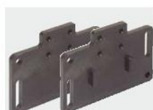
Пластины для FR и FX серий Пластины (в комплекте с крепежными болтами) с прорезями для регулирования актуального положения. Каждая пластина имеет несколько отверстий для установки, один для стандартных выключателей и другой для выключателей с устройством сброса.
