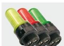
Индикаторы Индикаторы используются для визуализации изменения состояния электрических контактов. Они устанавливаются с сериями FL, FX, FZ или FS вворачивая в один из кабельных вводов не используемых для электрических кабелей. Степень защиты IP67.
